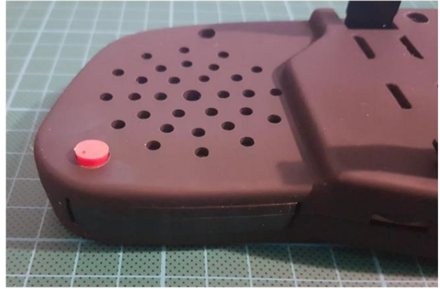
Slika 6: Osiguravanje pristupa testnom/programskom portu
