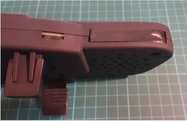
Slika 5: Poklopac priključka za testiranje/programiranje
